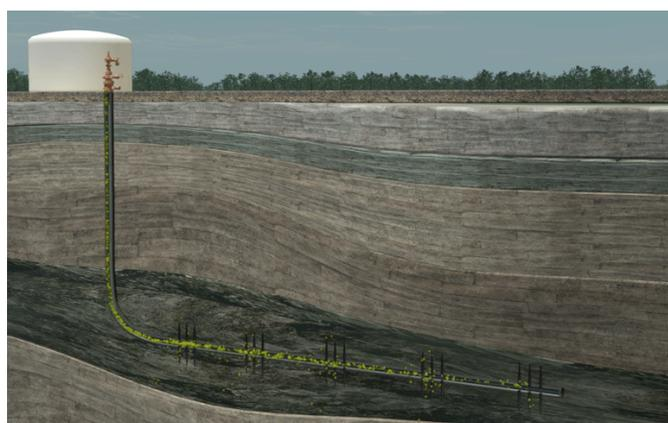
Fracturation hydraulique avec forage horizontal pour extraire le gaz de schiste
